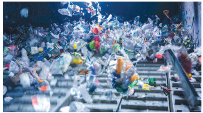
Die richtige Zuordnung der Materialien in der Sortieranlage ist eine wichtige Voraussetzung, um hochwertiges Rezyklat zu gewinnen (Bild: Veolia)
