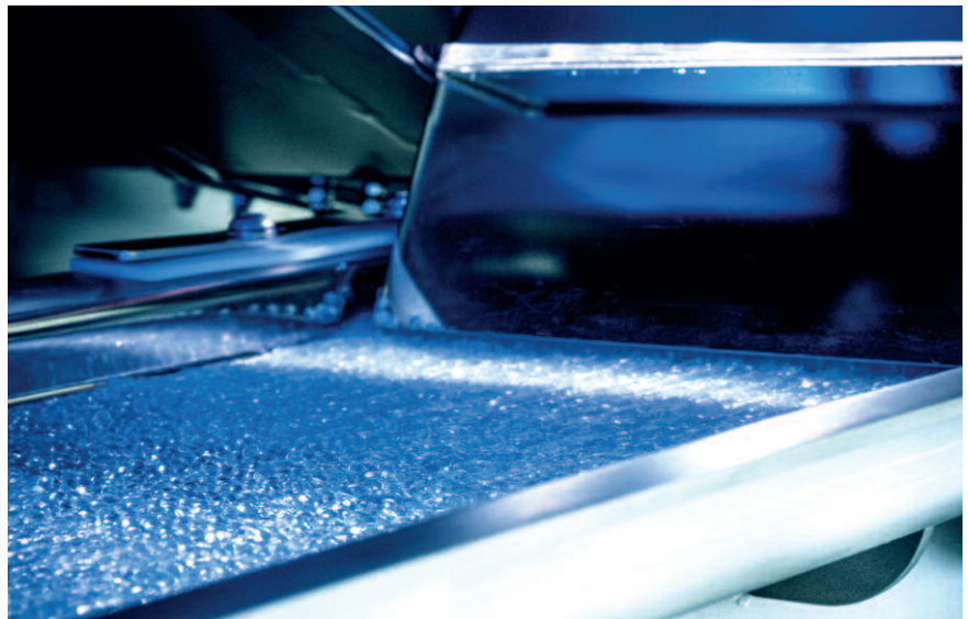
Beim PURITY SCANNER ADVANCED erfolgt die Förderung des Granulats zum Inspektionsbereich über eine Vibrationsrinne aus Edelstahl
