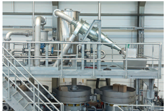
Die Hydrozyklonstufe für Doğa ist wie die gesamte PET-Recyclinglinie für eine Leistung von 100 Tonnen am Tag ausgelegt
